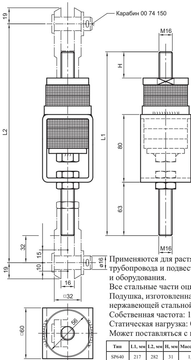
Применяются для растяжек вертикально расположенного трубопровода и подвести горизонтального трубопровода и оборудования.
